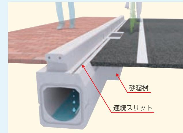
道路側に露出する側溝コンクリート面を側溝端面から10cm確保することで、自転車タイヤが側溝に乗ることを防ぎ安全に走行できます。
