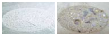
ダクトアル-FM 0.011cm 3 /cm 2 高強度コンクリート 0.074cm 3 /cm 2
