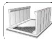
基礎砕石敷設後、均しコンクリートを打設する
