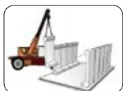
側壁部材を設置する。
