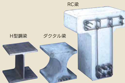
同一耐力とした場合の梁の断面例
