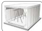
頂版部に配筋を行ない、頂版コンクリートを打設する。
