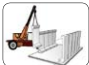
側壁部材を設置する。
