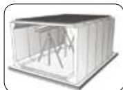
支保工を設置し頂版スラブを架設する。
