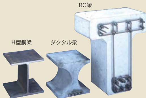
同一耐力とした場合の梁の断面例
