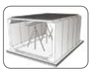
支保工を設置し頂版スラブを架設する。
