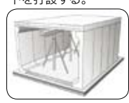
頂版部に配筋を行ない、頂版コンクリートを打設する。
