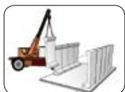
側壁部材を設置する。
